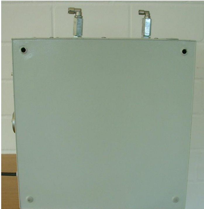
Abb. 6 Rückseite Metallbox. Für den Fall, dass die Metallbox mit der Dosieranlage nicht in einem Metallschrank untergebracht werden soll, kann diese über die Befestigungslöcher auch an einer Wand montiert werden.
